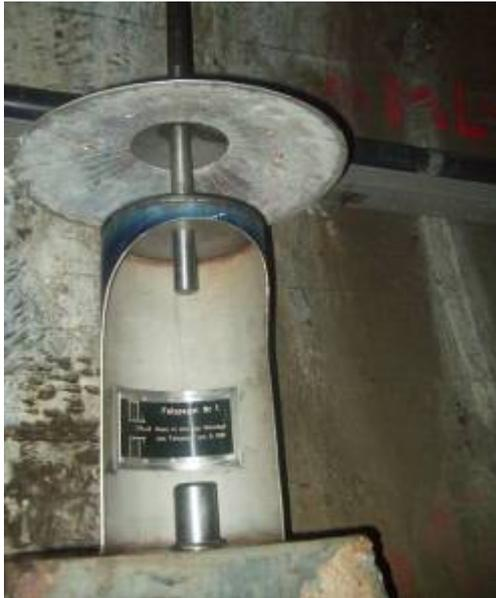
**Abb. 17** Messeinrichtung für die Relativverformung der Dammkrone
